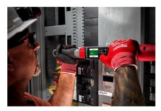
Die Rückmeldung über den korrekten Schraubenanzug erfolgt gleich vierfach: akustisch, mit einem LED-Licht, auf dem numerischen Display und zusätzlich auch mit einer spürbaren Vibration.
